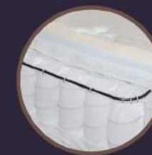
Khung lò xo: hệ thống lò xo túi 7 vùng cao 16cm.(thép hàm lượng carbon cao, dày 2mm và thép viền 5mm) Spring frame: Pocket spring system of 7 zone body supporting structure. Spring 16cm height, 2mm thickness and wire border thickness 5mm.
