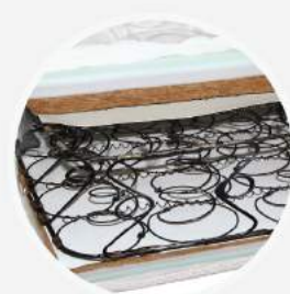
Khung lò xo Bonnel: Cao 17cm, được làm từ thép hàm lượng carbon cao, dày 2.4mm, các cây lò xo trợ lực 3.5mm và thép viền 5mm.
